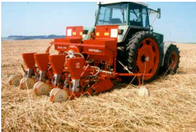
Abb. 17: Minimal-invasive Bodenbearbeitungsmethoden (hier Direktsaat in Mulchschicht) beeinflussen die Porosität und Struktur des Bodens (weniger Bodenbearbeitung - weniger gestörte Bodenstruktur)
