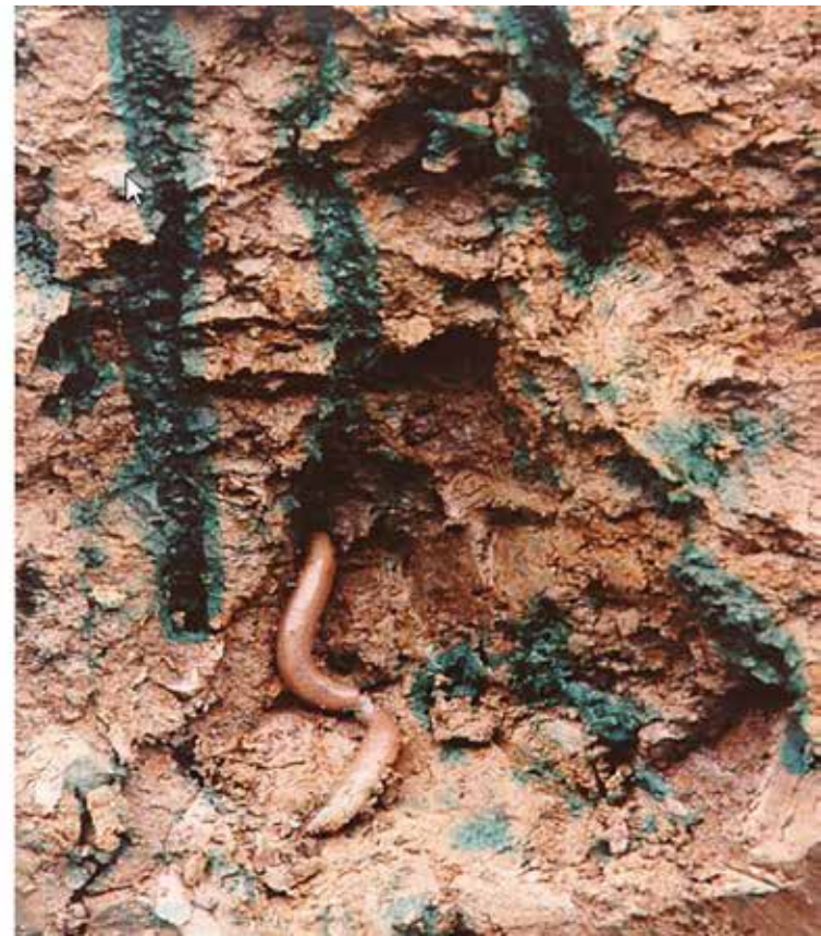
Abbildung 7: Muster des Wasserdurchflusses in einem Bodenprofil (links) und Färbungsmuster von Makroporen (rechts), die mittels Infiltrationsversuchen mit Farbstoff sichtbar gemacht wurden. (Anm. 9)
