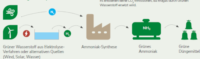
Abbildung 8: Verfahren zur Treibhausgasminderung in der N-Mineraldüngerherstellung
