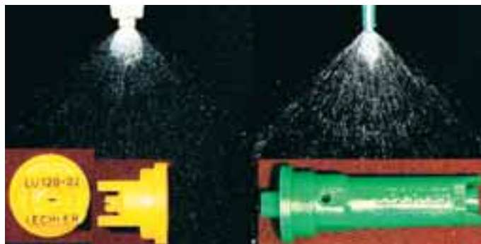
Die Flachstrahldüse (links) erzeugt viele relativ feine Tropfen, die nicht mehr sichtbar sind. Die Injektordüse produziert deutlich gröbere Tropfen.
