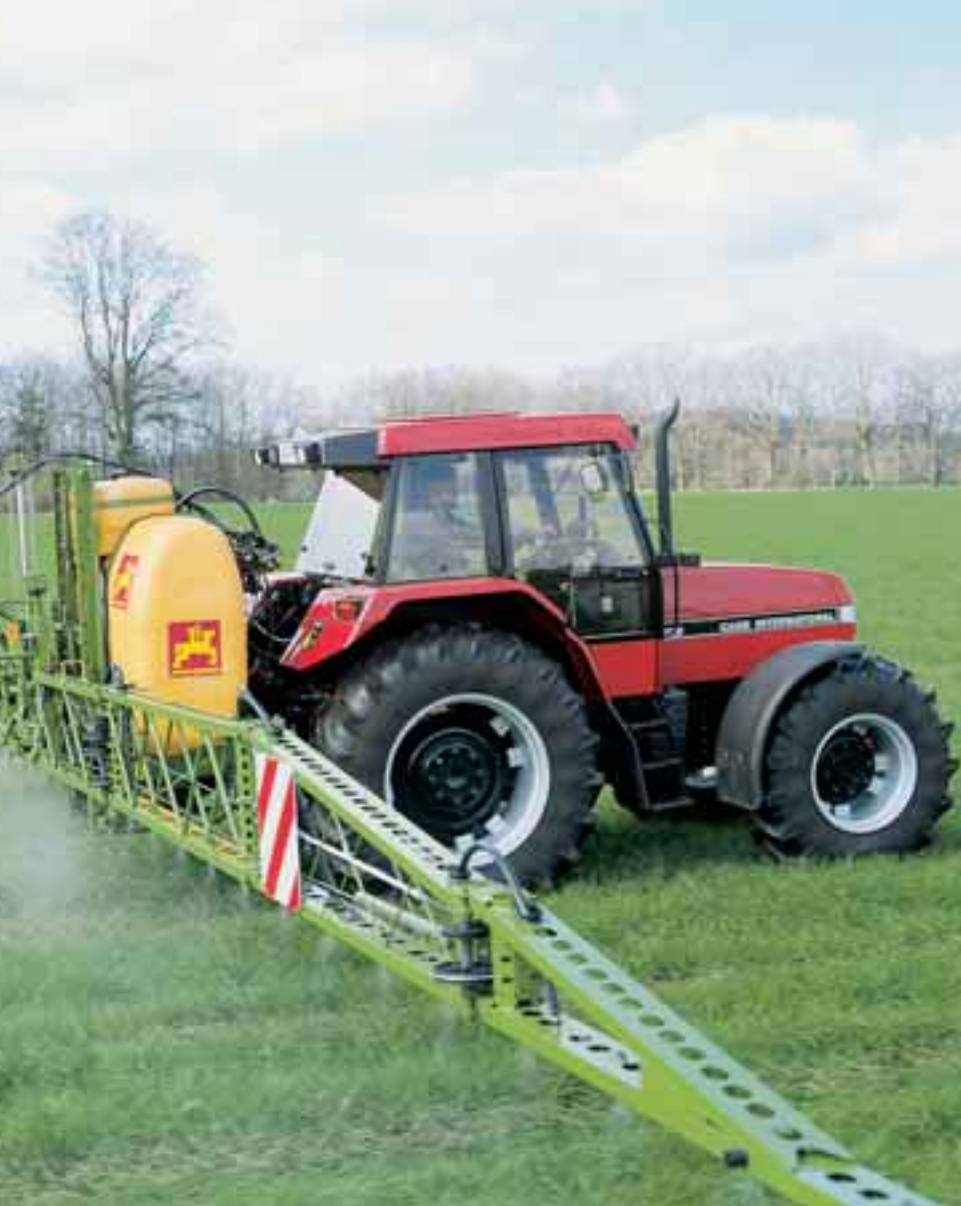
Spritzbild beim Ausbringen. Die deutlich sichtbare Sprühwolke ist durch Abdrift gefährdet.
